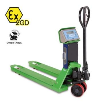
ATEX-Gabelhubwaage für den Einsatz in explosionsgefährdeten Bereichen (ZONEN 1 und 21 & 2 und 22) in den Schutzarten Ex II 2G IIB T4 Gb X und Ex II 2D IIIC T197°C Db X. Erhältlich auch in zugelassener Version für den Einsatz in Verbindung mit Dritten. Hergestellt, kalibriert und geeicht in Italien von Dini Argeo, unter Verwendung zertifizierter Prüfmassen.
